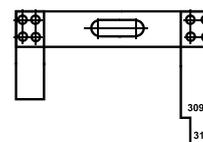
**T914.14.000** Штанген подпятника и пятника соединительной балки для контроля размеров подпятника и пятника при ремонте соединительных балок 4-х-осных тележек на ВЧД
