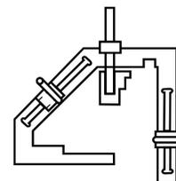
**T914.10.000** Штанген базового размера для контроля базового размера при измерении расстояния между наружными направляющими буксовых проемов рамы тележки грузового вагона
