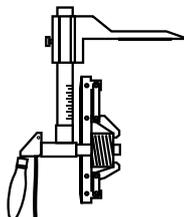
**T1328** Приспособление для контроля размеров корпуса боксы при ремонте тележек модели 18-100 на ВЧД, ВРЗ
