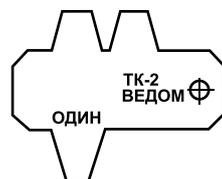
**Л2.0011.008** Шаблон для контроля геометрических размеров и шага ручьев ведомого шкива привода ТК-2 после переточки
