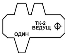
**Л2.0011.006** Шаблон для контроля геометрических размеров и шага ручьев ведущего шкива привода ТК-2 после переточки
