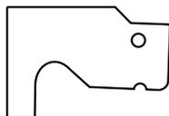
**T447.03.000** Шаблон максимальный для проверки профиля поверхности катания обработанного колеса
