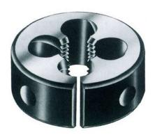
Плашка К 1 применяется для нарезки дюймовой трубной резьбы. Она соответствует стандартам, принятым у производителей трубного проката и фитингов для монтажа трубопроводных инженерных систем. Отличие изделия с маркировкой К от других видов резьбонарезного инструмента состоит в том, что с его помощью нарезается резьба конической формы. Они используются для обустройства трубопроводов высокого давления для подачи масла, ГСМ, сжатого воздуха, других газообразных и жидких сред.
