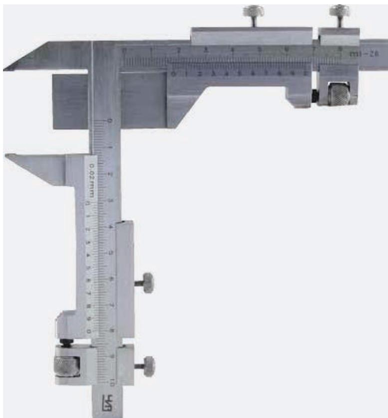
Предназначены для измерения расстояния между разноименными боковыми поверхностями (толщины) зуба цилиндрических прямозубых и косозубых колес внешнего зацепления 11-й и 12-й степеней точности ГОСТ 1643-81 по постоянной хорде или по хорде делительной окружности.
